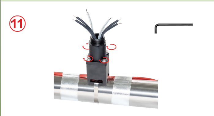
11: Drücke die Dichtung zusammen durch Festschrauben des oberen Fußteils mit den 4 Schrauben, bis die beiden Teile sich berühren.
