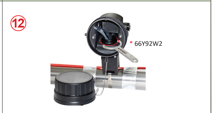
12: Lege die Dichtung in die obere Aussparung des Fußes und dann den Kasten darüber. Richte das Gehäuse in der gewünschten Position aus und ziehe dann die Zahnmutter an, bis sie einrastet.
