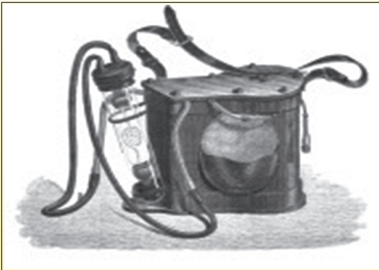
1862 Dumas et Benoît's Elektrische Grubenlampe
